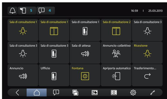
Con i modelli comfort dei citofoni di sistema è possibile realizzare senza bisogno di ulteriori accessori un sistema interno di chiamata e conversazione (Intercom). Gli apparecchi garantiscono le funzioni necessarie:
