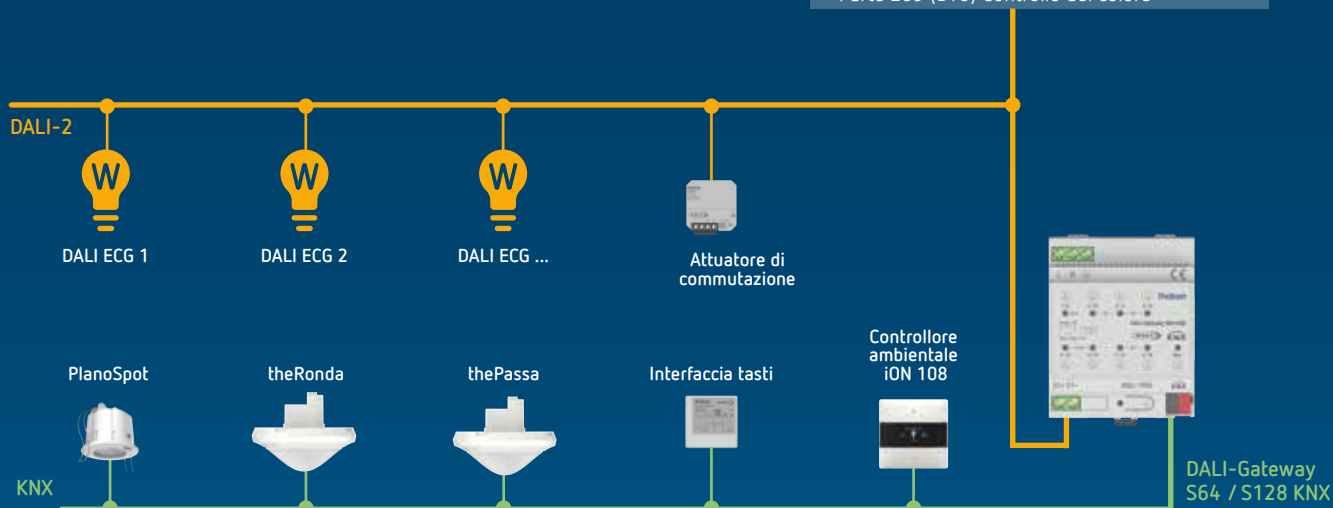
Schema del sistema: Controller applicativo Single-Master
